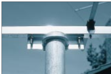
Bild 6: Selbstgebaute Halterung für Yagi-Antennen
