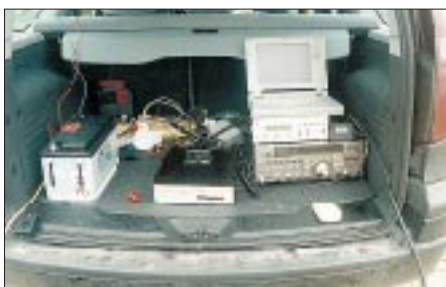
Das Mobilshack: Akkus, 200-W-PA, darauf Vorverstärker, Notebook mit OH51Y-Software, JUDSP3 (Prototyp von DL9AN), DCF77-Uhr und FT-736R; die Maus ist umgebaut und dient zum „Burst-Fangen“.
