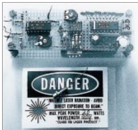
Bild 7: Strahlungsindikator mit Batterieeffach und Impulsdiode Fotos: Autor
