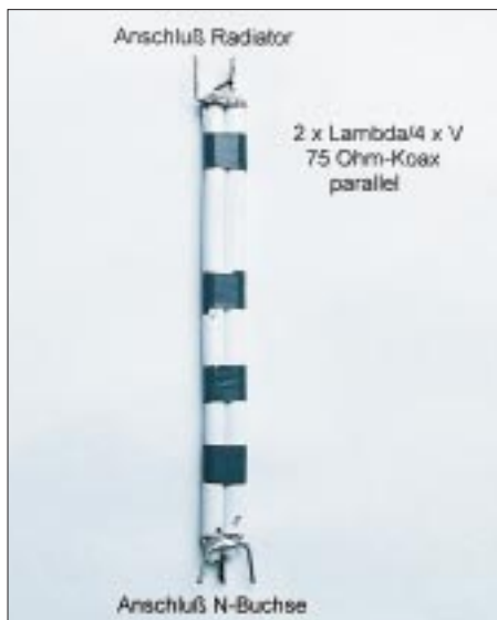
Bild 7: Fertige Anpassungsleitung vor dem Einbau
