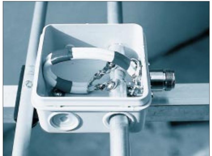
Bild 5: Praktische Ausführung der 28-Ω-Anpassung mit Dose und Koaxbuchse
